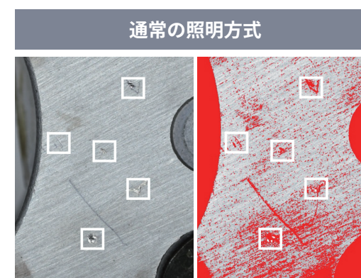
加工面は研磨痕と欠陥の区別が困難
